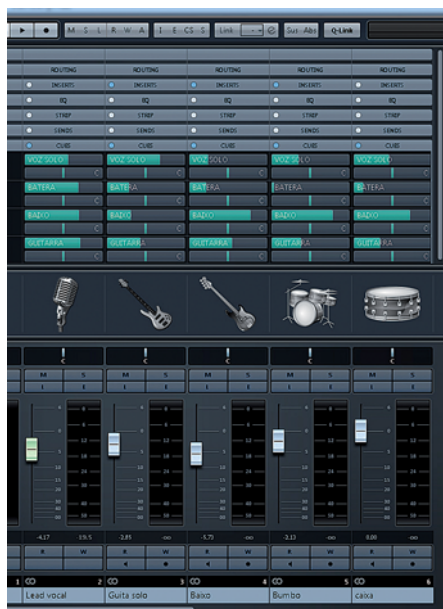
Figura 6 - Canais da sessão direcionados em sub-mixes às vias de retorno
